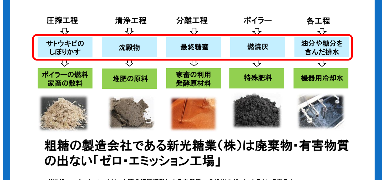
「ゼロ・エミッション工場」：製糖工程で出るサトウキビの搾りかすをはじめ、廃棄物は全て燃料や堆肥などで再利用される仕組みとなっている。
